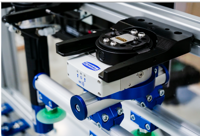
Pneumatischer Vakuum-Erzeuger RECB MATCH bei der Handhabung von Kartonverpackungen
